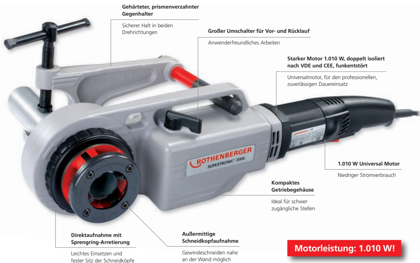
Leichtes Einsetzen der Schneidköpfe
