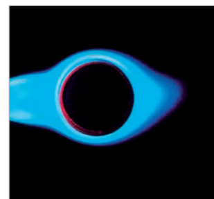
Hohe Flammentemperatur durch Zyklonverwirbelung
