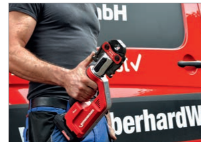
Nebeneffekt des Zwei-Zylinder-Aufbaus: Sie lässt sich bequem mit einer Hand bedienen.
