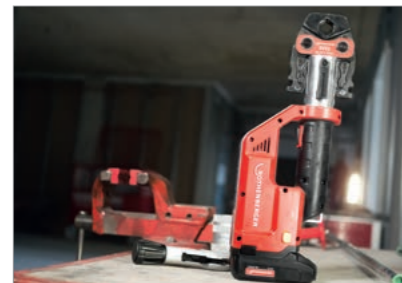
Unbenutzt oder beim Vormontieren steht sie stabil auf der Werkbank.
