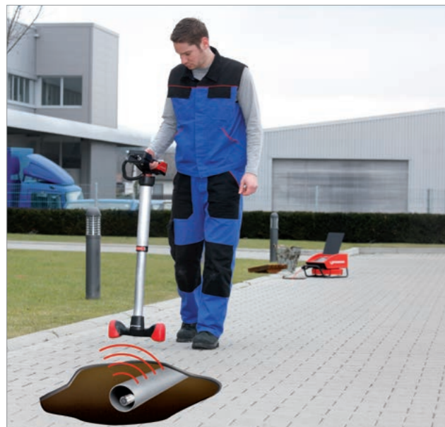
Leicht zu bedienendes Sondenortungsgerät inkl. Tiefenmessung.
