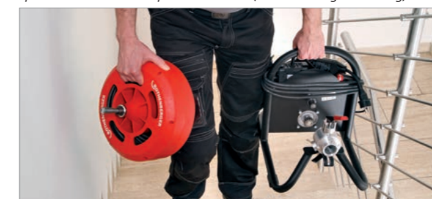
Spiraltrommel zum Transport abnehmbar (keine einseitige Belastung)
