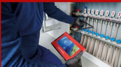
Das zusätzlich im Lieferumfang enthaltene TEC Modul ermöglicht die Inspektion von Hohlräumen.
